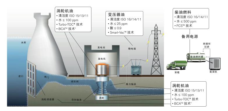
不论您用的是反应式涡轮或是脉冲式涡轮, 机油及润滑剂的清洁干燥对于保持正常运行 时间、按照计划进行维护的能力以及昂贵 设备的保护都是至关重要的。Kaydon Filtration 可以调整技术及解决方案的规模, 为1至1000兆瓦以上的水电设备提供支持。
